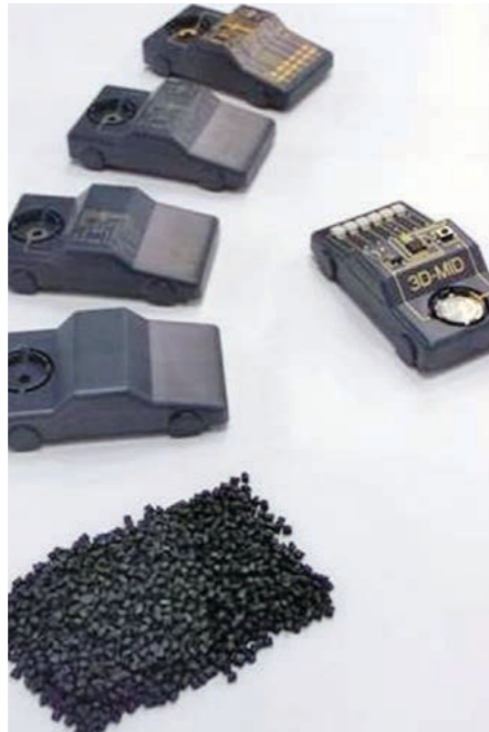
3-D MID Demonstrator – Fertigungsstufen
